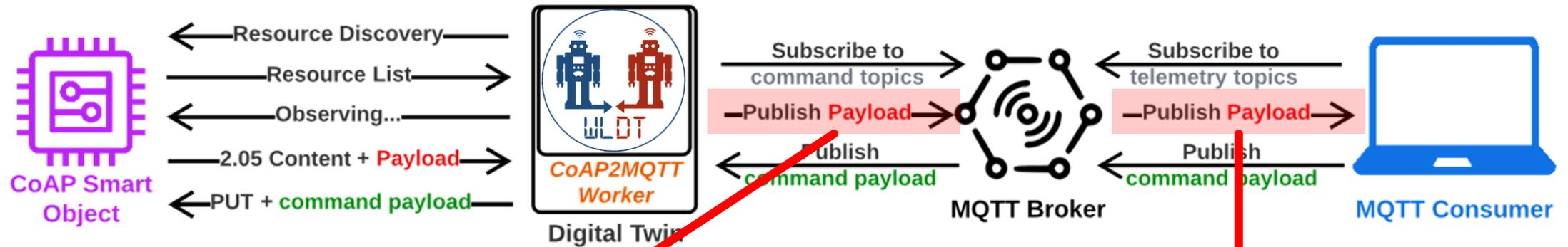
**4.** Ogni volta che arriva un messaggio dall'oggetto, il **Digital Twin** pubblicherà il payload del messaggio sul **Broker MQTT**
