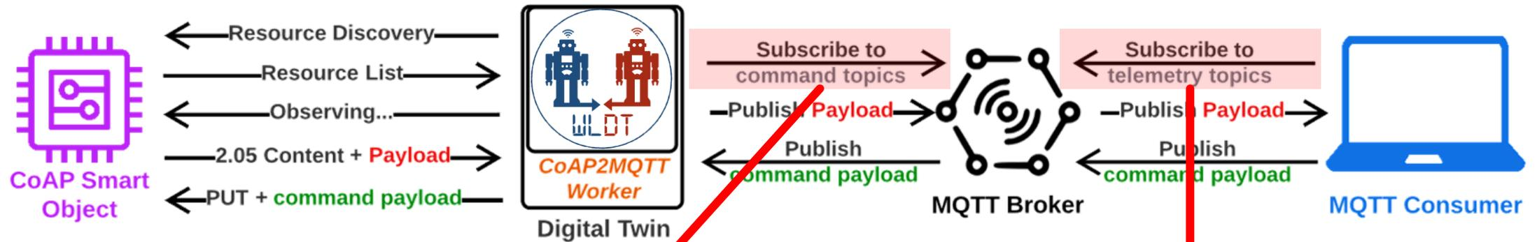
**1.** Il Digital Twin si sottoscrive ai topic di comando sul Broker MQTT
